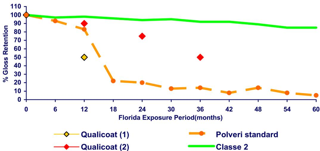
Metra Color, che già effettua i pretrattamenti sui profilati secondo le direttive Qualicoat ed è in possesso del metodo "Sea Side" del Qualicoat, che migliora la resistenza alla corrosione del prodotto verniciato, come dimostrato dai test in nebbia salina ed in Florida, vorrebbe condividere con il mercato la scelta di passare alla "Classe 2".
